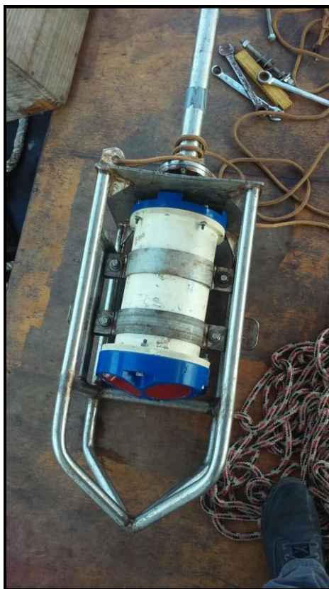
Figura 4: Estrutura utilizada para estabilização do ADCP.
